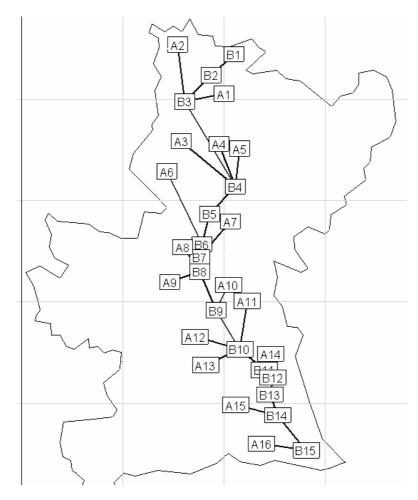
pps035\$xy contient les coordonnées, pps035\$contour le contour du bassin versant, pps035\$neig le graphe de voisinage (a et b sont voisins si et seulement si l'une est immédiatement en amont de l'autre).
