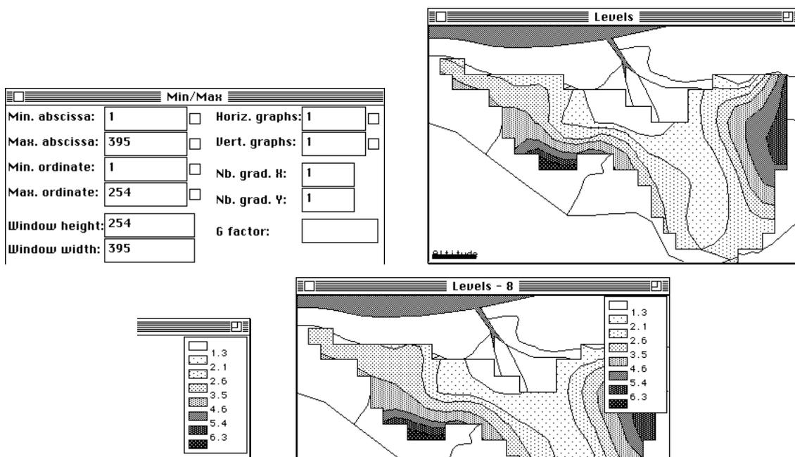
Copier la légende et coller dans la fenêtre de la carte. Jouer sur le coefficient de lissage :
